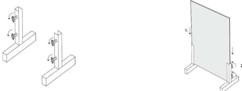
1. Noge postavite na tla, vijke odvijačite za okrog 15-20mm navzven.
